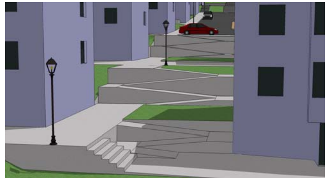
Eliminación das barreiras arquitectónicas mediante rampas para facilitar o acceso ás vivendas.
